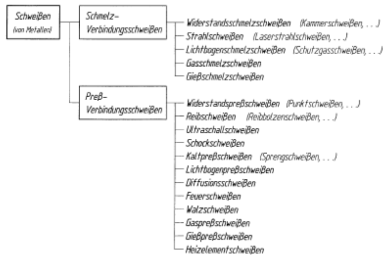
Abb. 2.2. Schweißverfahren (nach DIN 1910)
